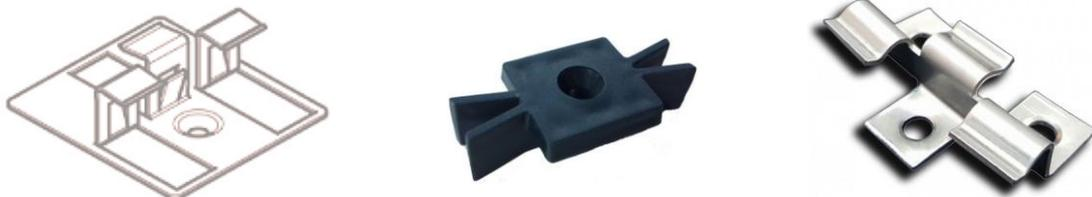
Он прикручивается к лаге с помощью самореза (лучше брать оцинкованные саморезы 3,5x30 с потайной головкой). Кляймер имеет специальные усики, которые вставляются в пазы досок и надежно их закрепляют.
